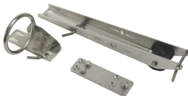
Die Ankerrolleneinheit ist etwa 47 cm gesamthaft lang und etwa der Kasten etwa 48 mm breit; vom Anfang bis zum Rollende, wo das Tau oder die Kette nach Unten wegläuft, sind es etwa 42 cm. Die Ankerrolle aus schwarzem PVC ist ca. 47 mm breit und hat einen 65 mm Durchmesser. Am Ende der Ankerrolle ist ein unverlierbarer L-Bolzen angebracht, den Sie zum Einfädeln öffnen können.
