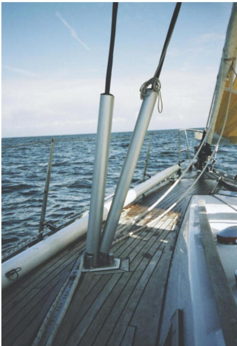
Diese aus seewasserbeständigem Alurohr hergestellten Wantenschonerhüllen mit Kunststoffendstück ermöglichen ein leichteres Wendemanöver, ohne das lästige Verhaken der Fockschot an den Wanten. Die Anpassung der Enden an die Püttingbeschläge erfolgt durch Anschneiden eines entsprechenden Winkels.
