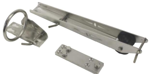
Die Ankerrolleneinheit ist etwa 47 cm gesamthaft lang und etwa der Kasten etwa 48 mm breit; vom Anfang bis zum Rollende, wo das Tau oder die Kette nach Unten wegläuft, sind es etwa 42 cm. Die Ankerrolle aus schwarzem PVC ist ca. 47 mm breit und hat einen 65 mm Durchmesser. Am Ende der Ankerrolle ist ein unverlierbarer L-Bolzen angebracht, den Sie zum Einfädeln öffnen können.
