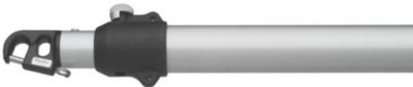
Die Arretierung erfolgt bei diesem schweren Modell über einen Federbolzen, der nach dem Einrasten in einer der vorgesehenen Bohrungen (alle 25 cm) eine feste Verbindung zwischen den beiden Rohren herstellt. Um ein Schleifen des Federstiftes auf dem Rohr während des Einstellens zu vermeiden, kann dieser durch Verdrehen des Knopfes in der oberen Stellung arretiert werden. Verwendbar für Boote bis ca. 10,5 m Länge oder einer Vorsegelgröße von ca. 40 m<sup>2</sup>.
